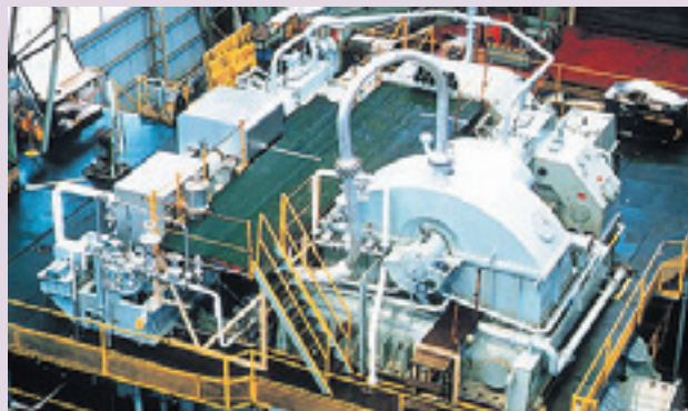
Steam turbine for LNG carrier
