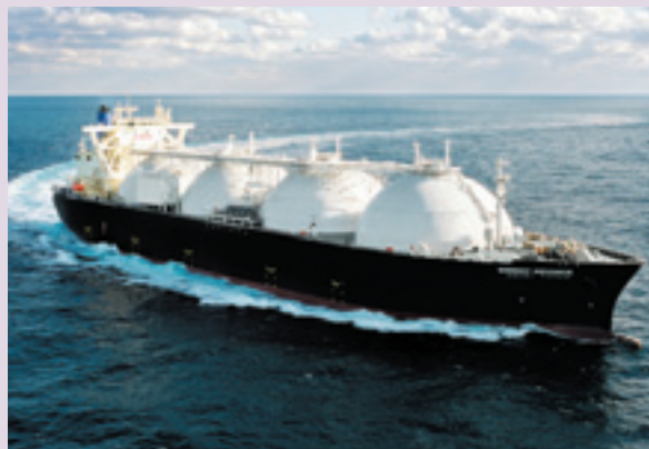
LNG carrier, Energy Advance, navigating with the load of 145,000 m 3 of LNG
